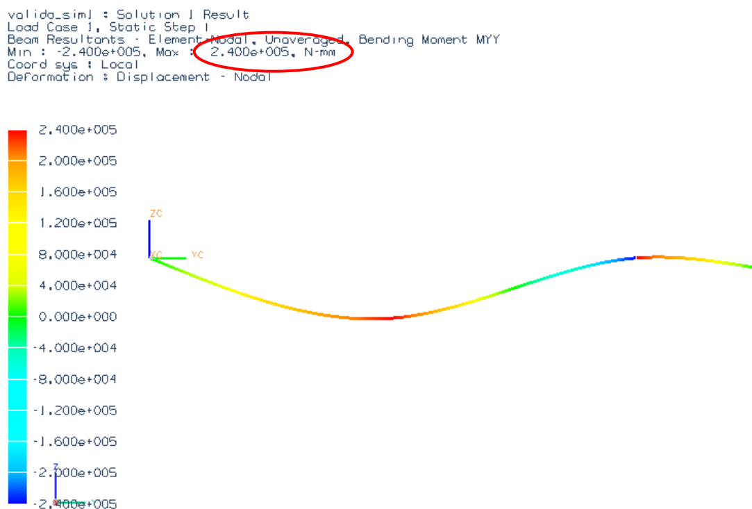
Figura 24. Momento fletor de uma viga similar à da Figura 23 simulada computacionalmente
