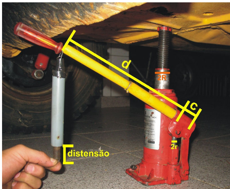
Figura 10. Arranjo para aferição do peso do eixo
